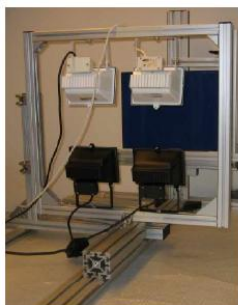
图 1：主动热成像实验室装备
